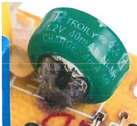
**OBRÁZEK 6 – Záložní Nikl-metal hydridový akumulátor.**<sup>17</sup> Názorný důkaz, že i tyto články ze začátku 21. století podléhají zkáze a že s touto okolností je třeba při péči o muzejní sbírky výpočetní techniky počítat.
